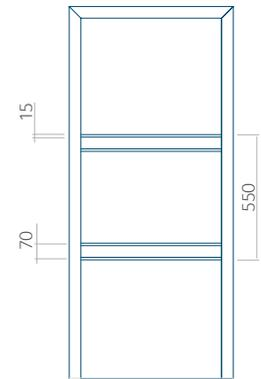
Die Platte ist in einer Version mit einer schmalen Nut (6 mm) erhältlich, in der es keine INOX-Anwendung gibt – Plattenmuster 110, während dieses Muster in der Holzplatte eine 4 mm Nut hat.
